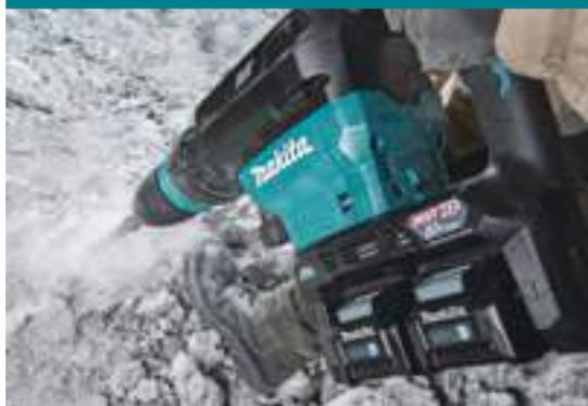
**VANTAGGI:** Ideale per la realizzazione (ambito civile ed industriale) di aperture in parete, scassi a terra, demolizioni di muretti e cordoli in muratura. Bilanciamento, peso e potenza come per il corrispettivo a filo per la categoria dei martelli da 10kg. L'uso è indicato per tutte quelle situazioni in cui la preparazione del lavoro da eseguire supera l'effettivo tempo di realizzo dell'opera e comunque tenendo in considerazione l'elevata mobilità garantita da una macchina senza cavo.
